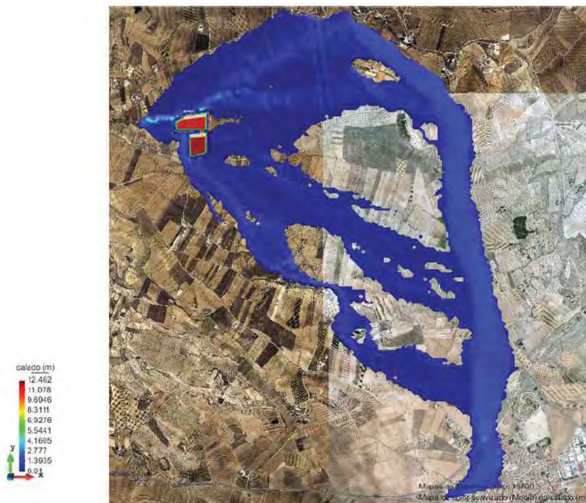
Figura nº 18. Avenida y calado por rotura balsa en el “Escenario 5”
