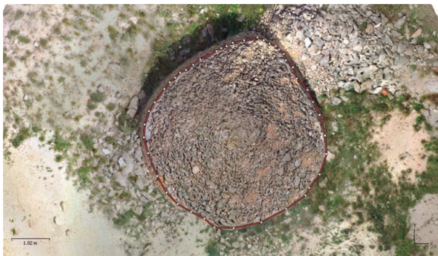
Figura 7. Polígono (contorno del cuco) sobre la ortofoto para el cálculo del volumen (fuente: DYSA-DRONES Y SERVICIOS AERONÁUTICOS)
